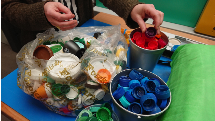
Abbildung 4: Der bereits nach Sorten vorsortierte Abfall wird hier nach Farben sortiert. Flaschendeckel eignen sich besonders gut zum Einschmelzen.
