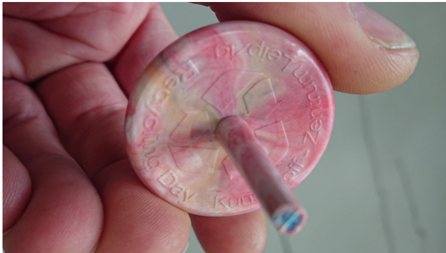
Abbildung 9: Der fertige Kreisel kühlt noch in der Form so stark ab, dass man ihn direkt in die Hand nehmen kann.
