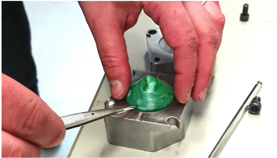
Abbildung 8: Nach dem Trennen der Form kann der fertige Kreisel entnommen werden.
